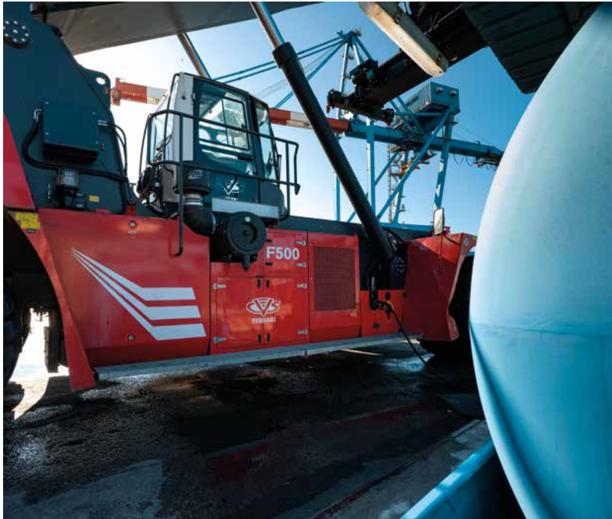
PSA SECH: la stazione di rifornimento di urea, un additivo che permette di ridurre le emissioni di ossidi di azoto NOx.
